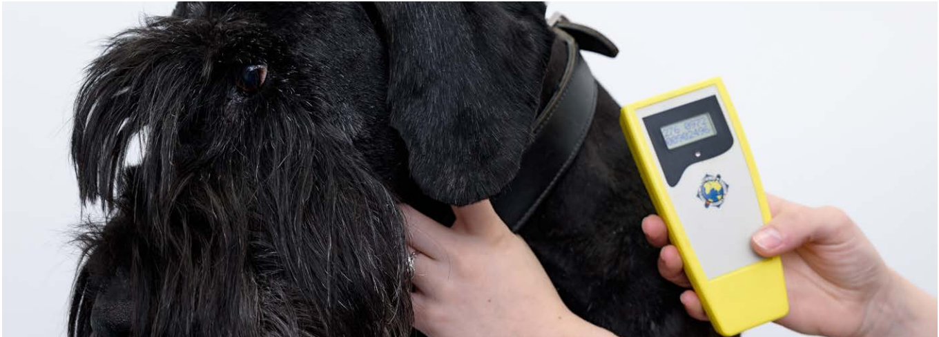
Abb. 3: Funketiketten, in der Fachsprache RFID genannt, sind weit verbreitet. Nicht nur in Chipkarten kommen sie zum Einsatz, sondern mit ihnen werden auch Tiere markiert. Weil sie so klein sind, sind dafür besonders effiziente Verschlüsselungsalgorithmen gefragt.
